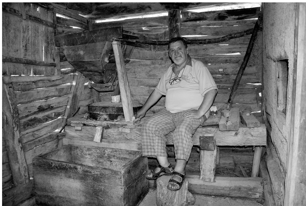
Sl. 24 Vlaška vodenica je remek-delo narodnog inženjerstva, koje su Vlasi umeli da naprave u planinskim zabitima samo pomoću sekirčeta, dleta zvanog „gin” i vatre. Vodenica je i mesto nastanka raznih priča i bajki. Foto: Marija Šalarević, 2018.
